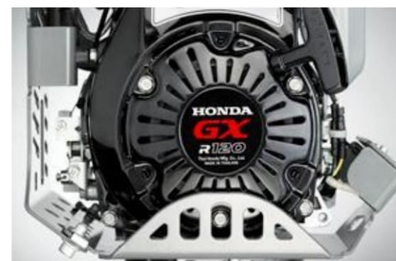
Per il difficile impiego in cantiere, con il modello GXR 120 di Honda avrete a vostra disposizione un motore potente. La protezione dalla mancanza di olio integrata controlla il livello dell'olio all'avviamento. Se è troppo basso, l'apparecchio si spegne automaticamente. Le emissioni dei costipatori a quattro tempi sono costituite in gran parte da CO. Nel complesso le emissioni di CO sono maggiori di 1/3 rispetto ai costipatori a due tempi.
