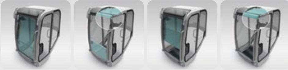
**Aperto in modo innovativo nella quotidianità del lavoro.** L'innovativo sistema di apertura per il parabrezza facilita la ventilazione della cabina nonché la comunicazione con il conducente. Una separata estrazione e posizionamento del vetro appartengono al passato.
