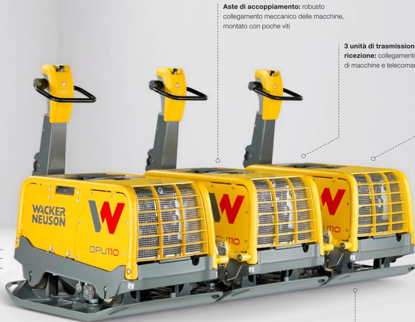
**Aste di accoppiamento:** robusto collegamento meccanico delle macchine, montato con poche viti
