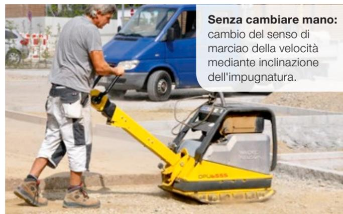
**Senza cambiare mano:** cambio del senso di marcia della velocità mediante inclinazione dell'impugnatura.
