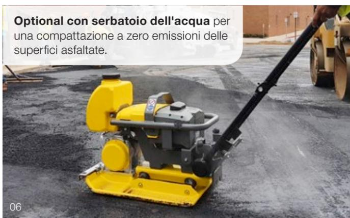
**Optional con serbatoio dell'acqua** per una compattazione a zero emissioni delle superfici asfaltate.
