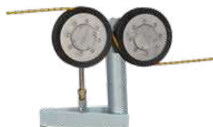
Puleggia di appoggio: elimina allentamenti del filo riducendo le oscillazioni
