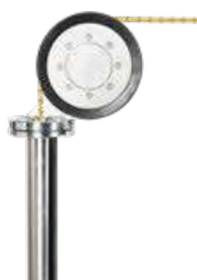
Puleggia di introduzione : per foro Ø 62 mm l'asola permette l'inserimento di filo giuntato
